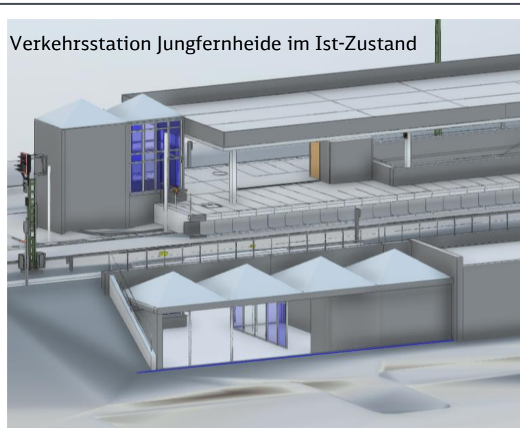
3D-Bestandsmodellierung der gesamten Strecke als Grundlage der BIM*-Planung
